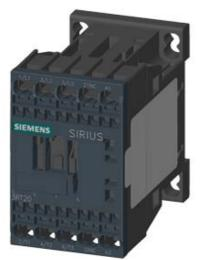
CONTACTOR, AC-3, 4KW/400V, 1NC, AC 400V, 50/60 HZ, 3-POLE, SZ S00 SPRING-LOADED TERMINAL
