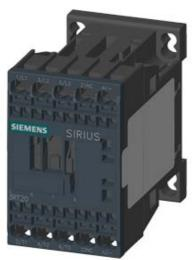
CONTACTOR, AC-3, 4KW/400V, 1NC, DC 125V, 3-POLE, SZ S00 SPRING-LOADED TERMINAL
