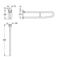
Stützklappgriff ohne WC-Rollenhalter für Aufputzmontage, Chromnickelstahl, Oberfläche seidenmatt, Schliff mit rutschhemmender Wirkung, Rohrdurchmesser 32 mm, Wandstärke 1,2 mm, in Bügelform, Schutz gegen ungewolltes Herunterklappen, Anschlagdämpfer aus Gummi, geprüft und zertifiziert (LGA), 4 mm starke Montageplatte mit drei Befestigungslöchern, inklusive Edelstahlschrauben und Dübel. Befestigung nur für Beton-Mauerwerk geeignet.
