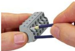
Eindrähtige Leiter  $\geq 0,5 \text{ mm}^2$  und feindrähtige Leiter mit aufgedrimpter Aderendhülse können direkt gesteckt werden. Durch zwei Prüföffnungen kann eine Tippkontaktierung mit Prüfspitzen erfolgen.
