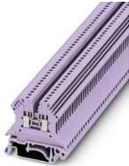
Durchgangsklemme, Nennspannung: 500 V, Nennstrom: 17,5 A, Anschlussart: Schraubanschluss, Bemessungsquerschnitt: 1,5 mm<sup>2</sup>, Querschnitt: 0,14 mm<sup>2</sup> - 1,5 mm<sup>2</sup>, Montageart: NS 35/7,5, NS 35/15, NS 32, Farbe: violett
