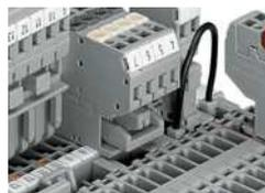
Schachtelbrücken in 2-Leiter-Federleiste und Querbrücken in Basisklemmen
