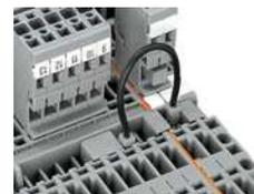
Brücken von Basisklemmen mit steckbaren Leitungsbrücken oder Querbrücken, auch über die Zwischenplatte hinweg
