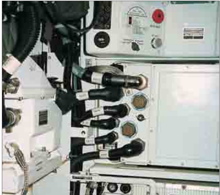
Platzsparender Einbau durch rechtwinklige Steckverbinder-Endgehäuse.
