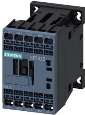
Leistungsschütz, AC-3 9 A, 4 kW / 400 V 1 S, DC 24 V 0,7-1,25\*US 3-polig, Baugröße S00 Federzuganschluss geeignet für SPS-Ausgänge nicht mit Hilfsschalter erweiterbar
