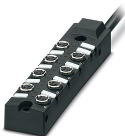
Sensor-/Aktor-Box, Anwendung: Standard, Anschlussart: M8-Buchse Metall, Anzahl der Steckplätze: 8, Polzahl: 3, Kodierung: A - Standard, Steckplatzbelegung: einfach, Statusanzeige: Ja, pnp; Stammleitungsanschluss: Festanschluss 180°, PUR/PVC, Leitungslänge: 10 m, Schirmung: nein
