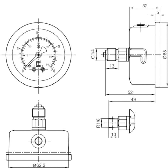
Haltering 3530132602 für Schaltafeleinbau separat bestellen.
