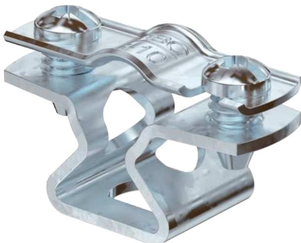
Abstandschele zur Montage von Rohren und Kabeln an Wand, Decke und Boden. Mit selbstsicherndem Oberteil. Befestigung über Langloch. Zugelassen für den Funktionserhalt nach DIN 4102 Teil 12, Funktionserhaltklassen E 30 bis E 90.
