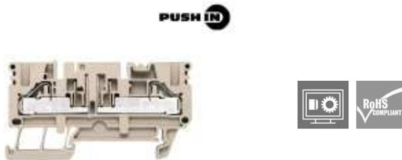
Bei einigen Anwendungen ist ein Prüfabgriff oder ein Trennelement an der Durchgangsklemme für Test- und Sicherheitszwecke sinnvoll. Mit Prüftrennreihenklemmen messen Sie Stromkreise im spannungsfreien Zustand. Während Luft- und Kriechstrecken der Trennstellen nicht maßlich beurteilt werden, muss die angegebene Bemessungsstoßspannungsfestigkeit nachgewiesen werden.
