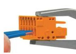
Leiter anschließen – Betätigung des CAGE CLAMP®-Anschlusses mit Schraubendreher (2,5 x 0,4) mm – rechtwinklig zur Leiteranschlussrichtung.
