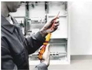
Die Kraftform Kompakt VDE Sets beinhalten einen isolierten Handgriff sowie isolierte Wechselklingen zum Austausch ohne Sonderwerkzeug.
