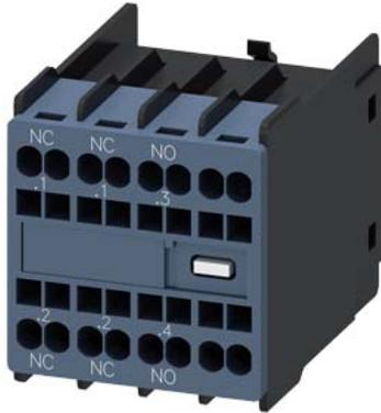
Hilfsschalter frontseitig, 1 S + 2 Ö Strombahn 1 Ö, 1 S, 1 S für 3RH2 und 3RT2 Federzuganschluss .1/.2 , .1/.2 , .3/.4
