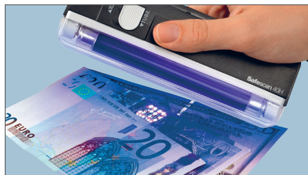
PRÜFUNG DER UV MERKMALE DER BANKNOTE
