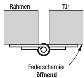
Der Pfeil zeigt die Drehrichtung des Scharnier unter Einwirkung der Feder an.
