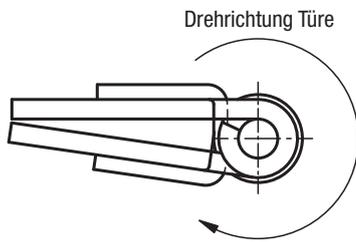
Scharniere mit Öffnungsfeder, öffnend
