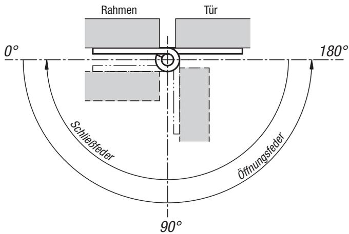
Entwicklung des Drehmoments der Federscharniere je nach Winkelposition:
