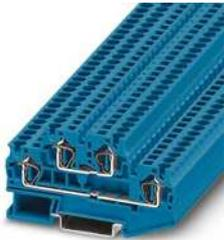
Doppelstock-Zugfederklemme, Nennspannung: 500 V, Nennstrom: 30 A, Anschlussart: Zugfederanschluss, 1. und 2. Etage, Bemessungsquerschnitt: 4 mm<sup>2</sup>, Querschnitt: 0,08 mm<sup>2</sup> - 6 mm<sup>2</sup>, Montageart: NS 35/7,5, NS 35/15, Farbe: blau
