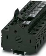
Sicherungsreihenklemme, Art der Sicherung: Glas / Keramik / ..., Sicherungstyp: Class CC, Nennspannung: 600 V, Nennstrom: 30 A, Anschlussart: Schraubanschluss, Bemessungsquerschnitt: 25 mm<sup>2</sup>, Querschnitt: 1,5 mm<sup>2</sup>- 25 mm<sup>2</sup>, Montageart: NS 35/7,5, NS 35/15, Farbe: schwarz
