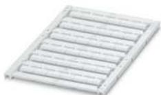
Marker für Klemmen, Matte, weiß, unbeschriftet, beschriftbar mit: TOPMARK NEO, TOPMARK LASER, BLUEMARK ID COLOR, BLUEMARK ID, BLUEMARK CLED, THERMOMARK PRIME, THERMOMARK CARD 2.0, THERMOMARK CARD, Montageart: verrasten, für Klemmenbreite: 10,2 mm, Schriftfeldgröße: 9,4 x 4,7 mm, Anzahl der Einzelschilder: 36
