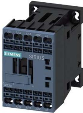
Leistungsschütz, AC-3 16 A, 7,5 kW / 400 V 1 Ö, AC 24 V, 50/60 Hz 3-polig, Baugröße S00 Federzuganschluss
