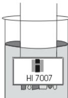
Bei einem akzeptierten pH-Puffer wird 1 Sekunde lang OK 1 angezeigt. Ist nur eine 1-Punkt-Kalibrierung gewünscht kann nun der Kalibriervorgang mittels der MODE-Taste beendet werden. Wird der Puffer nicht erkannt, erscheint nach ca. 12 Sekunden die Anzeige WRNG (WRONG). Prüfen Sie die Elektrode und den verwendeten Puffer auf Sauberkeit.
