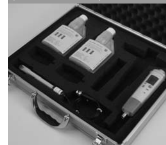
Einhand pH/°C-Messgerät, pH3-Sondenkopf mit BNC-Schnittstelle, pH-Sonde Typ 01, Aufbewahrungskappe mit Gel, Kalibrierdosierflaschen 250 ml pH 4+7, TopSafe, Gürtel-/Wandhalterung und Alukoffer
