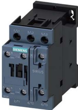
Leistungsschütz, AC-3 17 A, 7,5 kW / 400 V 1 S + 1 Ö, AC 230 V, 50 Hz, 3-polig, Baugröße S0 Schraubanschluss
