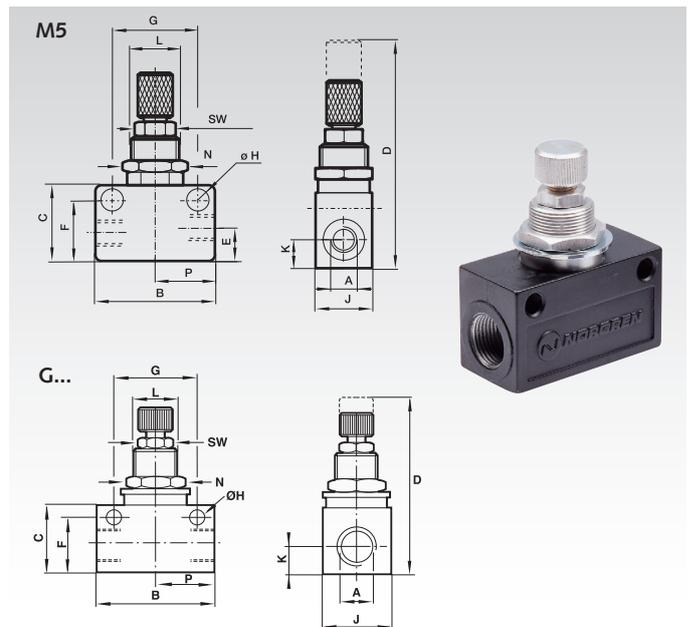
Bestellangaben z.B.: Artikel-Nr. 86540500, Drosselrückschlagventile, Drosselung in eine Richtung, Gewinde M5
