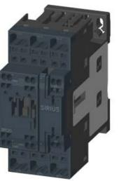
CONTACTOR, AC-3, 4KW/400V, 1NO+1NC, AC 230V 50/60HZ, 3-POLE, SZ S0 SPRING-LOADED TERMINAL
