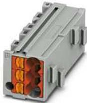
Rangierwabe, Nennspannung: 500 V, Nennstrom: 17,5 A, Anschlussart: Push-in-Anschluss, Querschnitt: 0,14 mm<sup>2</sup> - 2,5 mm<sup>2</sup>, Montage: aufrasten auf Tragschienenadapter, aufrasten auf Deckelflansch, Farbe: grau, Farbe Anschlusselemente: rot
