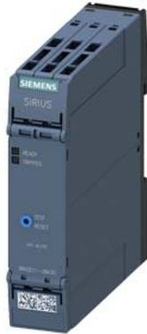
Thermistor-Motorschutzrelais Standard-Auswertegerät 22,5 mm Gehäuse Federzugklemme 2 Wechsler US = AC/DC 24 V Hand/Fern-RESET mit ATEX-Zulassung 2 LEDs (READY/TRIPPED) galvanische Trennung Test-/RESET-Taste Drahtbruchüberwachung Kurzschlussüberwachung
