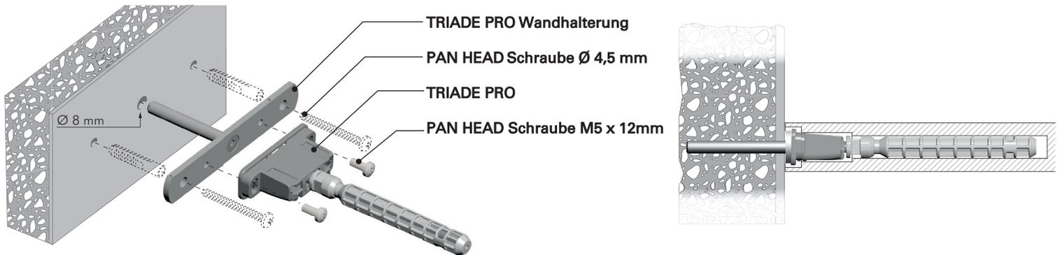
Die Wandhalterung gewährleistet eine stabilere Befestigung an der Wand.
