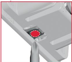
Feststellschraube um die Verstellmöglichkeit zu sichern
