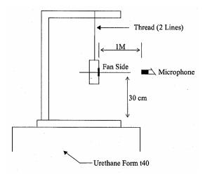
1 METER FROM MICROPHONE TO FAN INTAKE
