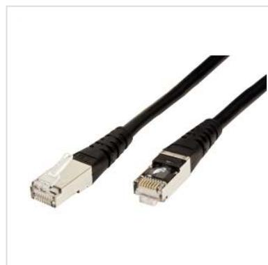
Cordon confectionné doublement blindé (PiMF) avec des connecteurs blindés RJ45 de qualité, assignation des connecteurs 1:1 selon la norme EIA / TIA 568A. Structure: tresse de 8 fils, blindage par paire par feuille d'aluminium. Blindage total par tresse en cuivre étamé. Contacts dorés.
