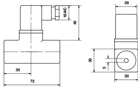
**Anschlussflansch mit DS-Interface 18D und montiertem 18D Druckschalter**
