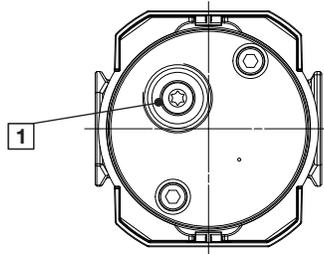
1 1/2" Entlüftungsanschluss (NPT oder ISO G)
