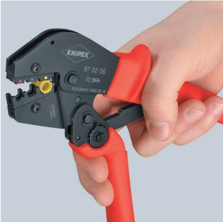
Primer paso: mover el mango con dos dedos hasta que ambas bocas toquen el conector para ser crimpado
