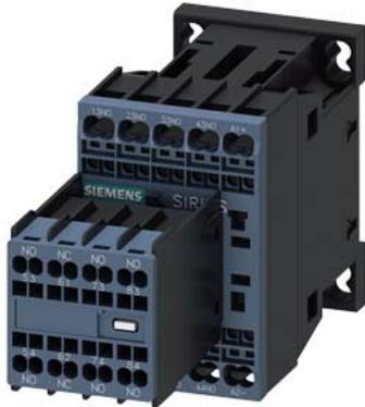
Hilfsschütz, 7 S + 1 Ö, DC 24 V, mit integrierter Diode Baugröße. S00, Federzuganschluss, Hilfsschalter lösbar
