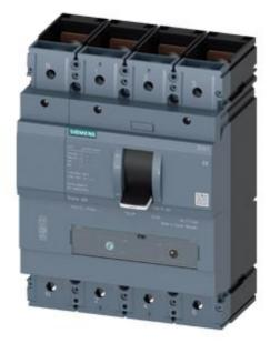
Leistungsschalter 3VA1 IEC Frame 400 Schaltvermögenklasse C Icu=110kA @ 415 V 4-polig, Anlagenschutz TM240, ATAM, In=320A Überlastschutz Ir=224A ...320A Kurzschlussschutz Ii=5...10 x In N-Leiterschutz 1 Schraubenflachanschluss
