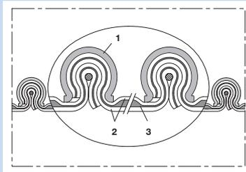
Tuyau haute température, tuyau à profilé de serrage (tuyau clippé), multi-couches, isolant, (jusqu'à +1100°C)
