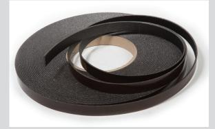
SHERPA Fire Stop 2.5 ist ein intumeszierendes Brandschutzlaminat auf Graphitbasis mit einer Starttemperatur von ca. 150° C.
