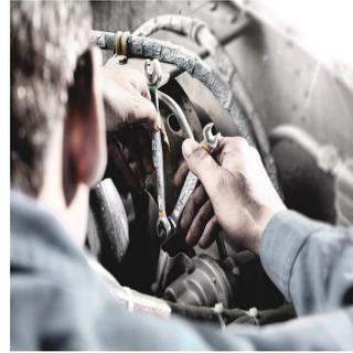
Der Doppelmaul Joker eignet sich hervorragend zum Kontern bei Schraube und Mutter.
