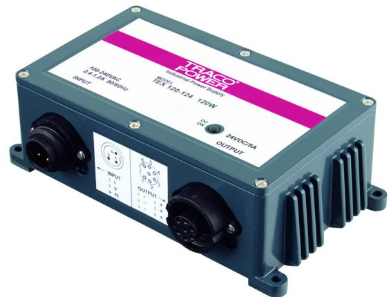
Diese Schaltnetzteile wurden für den Einsatz in extremen Umgebungen entwickelt. Das robuste Druckguss-Aluminium Gehäuse ist resistent gegen Wasser, Eis, Öl und Staub nach IP 67 und NEMA 4X Standard. Das Metallgehäuse mit dem effizienten Kühlkörper erlaubt die Abnahme der vollen Leistung ohne Einsatz eines zusätzlichen Lüfters bei einer Umgebungstemperatur von bis zu +60 °C. Die schock- und vibrationsgeschützte Konstruktion ermöglicht die Montage der Stromversorgung direkt an der Maschine.
