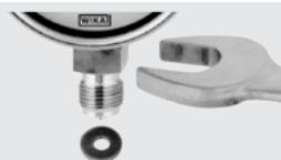
Zur Abdichtung der Druckmessgeräteanschlüsse mit zylindrischen Gewinde an der Dichtfläche ① sind Flachdichtungen, Dichtlinsen oder WIKA-Profilabdichtungen einzusetzen. Bei kegeligen Gewinde (z. B. NPT-Gewinde) erfolgt die Abdichtung im Gewinde ②, mit zusätzlichen Dichtwerkstoffen, wie z.B. PTFE-Band (EN 837-2).
