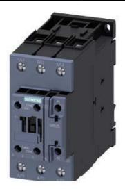
SCHUETZ,AC3:22KW/400V, 1S+1OE,AC 92V50HZ/110V60HZ, 3POL, BGR. S2, SCHRAUBANSCHLUSS
