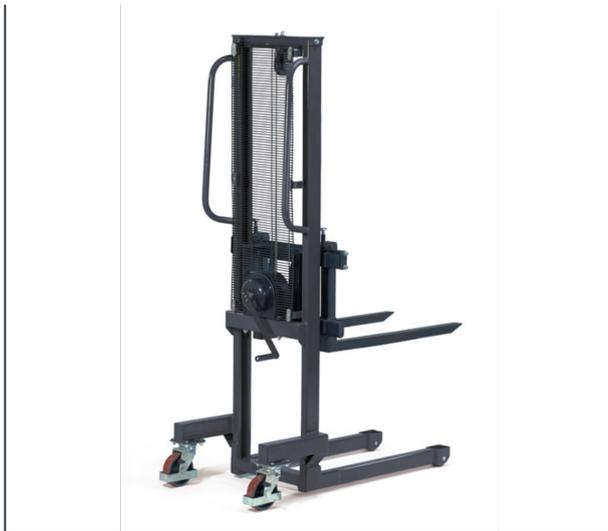
Für den gelegentlichen Einsatz als Hub- und Transportgerät. Stabile Profilstahl-Konstruktion mit Rohrschiebegriffen, pulverbeschichtet anthrazit RAL 7016. Völlig wartungsfrei. Hubantrieb durch Sicherheits-Handwinde. Gabeln verstellbar. 2 Lenkrollen, Räder Polyurethan-Bereifung 150 x 40 mm, und 2 Gabelrollen Nylon 80 x 47 mm. Lenkrollen mit Feststeller. Lastschwerpunktstand 6851/6852: 400/500 mm, Hub pro Kurbelumdrehung 6851/6852: 40/22 mm, Gesamthöhe 6851/6852: 2030 mm
