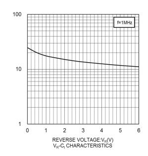
CAPACITANCE BETWEEN TERMINALS:C<sub>t</sub>(pF)
