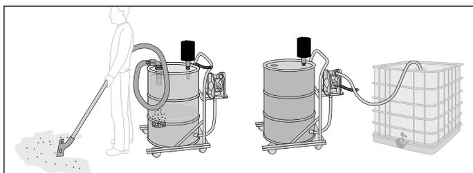
PumpOut saugt Flüssigkeit vom Boden und pumpt sie in einen IBC.
