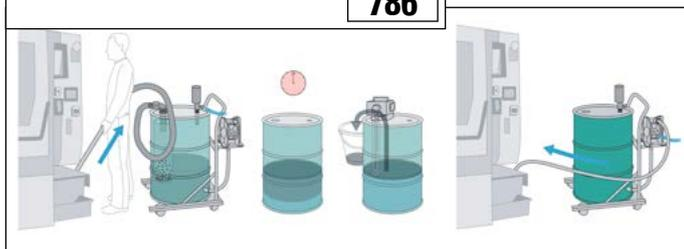
Kombinierter Einsatz: PumpOut saugt Kühlwasser aus einer Maschine und trennt dabei Partikel von der Flüssigkeit. Ein Ölbandskimmer auf der 2"-Öffnung des Behälters schöpft das Öl von der Oberfläche ab. Dann wird die gereinigte Flüssigkeit in die Maschine zurückgepumpt.
