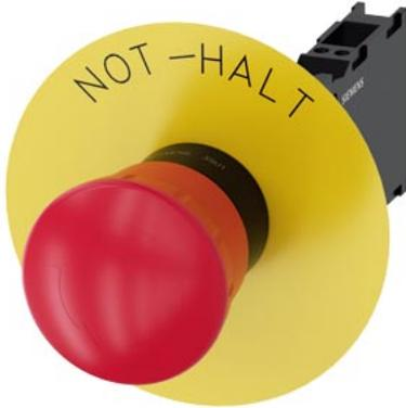
NOT-HALT-Pilzdrucktaster, 22 mm, rund, Kunststoff, rot, 40 mm, zwangsläufige Verrastung, gemäß DIN EN ISO 13850, Drehentriegelung, mit gelbem Unterlegschild, Beschriftung: NOT-HALT, mit Halter, 1S+1Ö, Federzuganschluss
