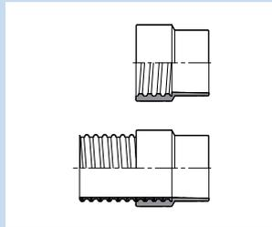
Weiche Muffe zum Aufschieben auf Stutzen oder Einschieben in Rohre, lebensmittelecht
