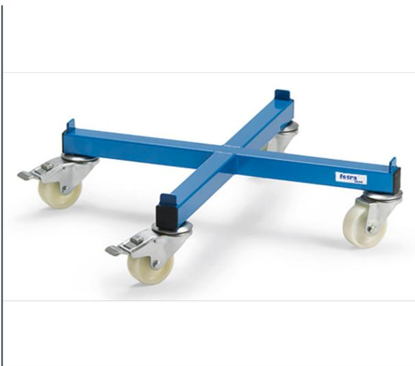
Fassroller für stehenden Transport oder Lagerung von 200-Liter-Stahlblechfässern. Geschweißtes Kreuz aus Quadratrohr mit Abrutschkanten, pulverbeschichtet blau RAL 5007. 4 Lenkrollen, 2 Stück mit Feststeller. Räder Polyamid, Naben mit Gleitlagerung.
