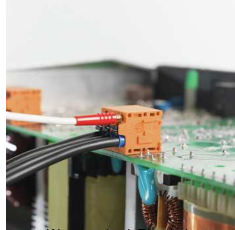
Wartung durch Testpunkt
