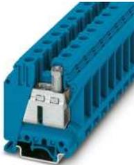
Durchgangsklemme, mit Innensechskantschrauben, Nennspannung: 1000 V, Nennstrom: 150 A, Anschlussart: Schraubanschluss, Querschnitt: 0,75 mm<sup>2</sup> - 50 mm<sup>2</sup>, Montageart: NS 35/7,5, NS 35/15, NS 32, Farbe: blau
