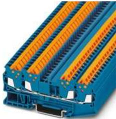
Durchgangsklemme, Nennspannung: 800 V, Nennstrom: 17,5 A, Anschlussart: Schnellanschluss, 1. Etage, Bemessungsquerschnitt: 1,5 mm<sup>2</sup>, Querschnitt: 0,25 mm<sup>2</sup> - 1,5 mm<sup>2</sup>, Montageart: NS 35/7,5, NS 35/7,5, Farbe: blau
