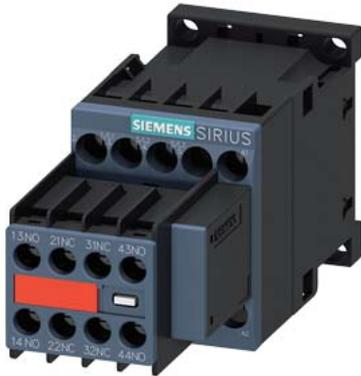
Leistungsschütz, AC-3e/AC-3, 7 A, 3 kW / 400 V, 3-polig, AC 230 V, 50/60 Hz, mit aufgestecktem Varistor, Hilfskontakte: 2 S + 2 Ö, Schraubanschluss, Baugröße: S00, Hilfsschalter unlösbar
